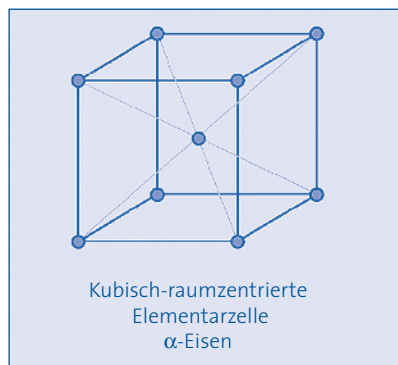
Bild 3: Gitterstruktur der kubisch-raumzentrierten ( \alpha -Eisen) und der kubisch-flächenzentrierten ( \gamma -Eisen) Elementarzelle
