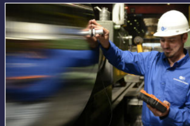
Kyle Sims während einer Ultraschallprüfung
