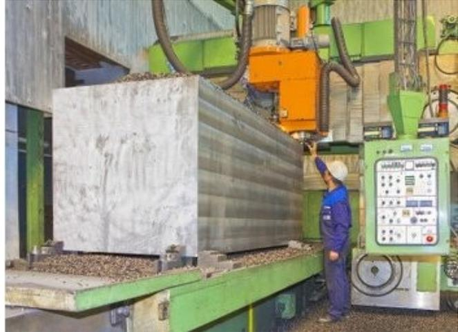
*25-Tonnen-Hydraulikblock während der Bearbeitung
